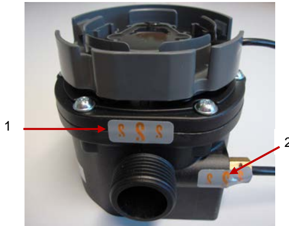
Sigilli di fabbrica sulla volumetrica (1) e sulla sonda di temperatura (2) del Superstatic 789
