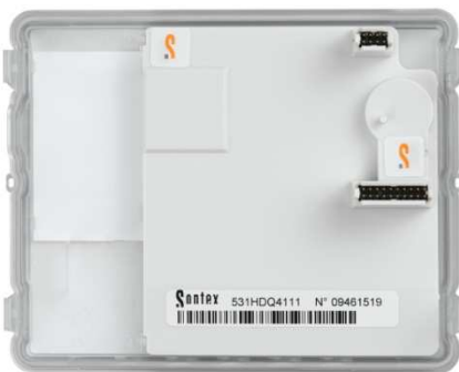
Eichplomben / Piombini di taratura Ab Werk plombiert – Piombini installati in fabbrica
